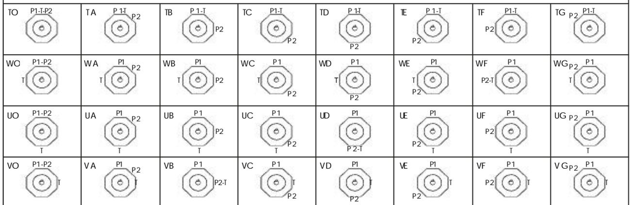
P1=第一级泵的出口 P2=第二级泵的出口 T=进口
