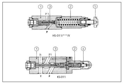
HS是滑阀 型直动式顺序阀。 KS 是滑阀 型两级 顺序阀。
