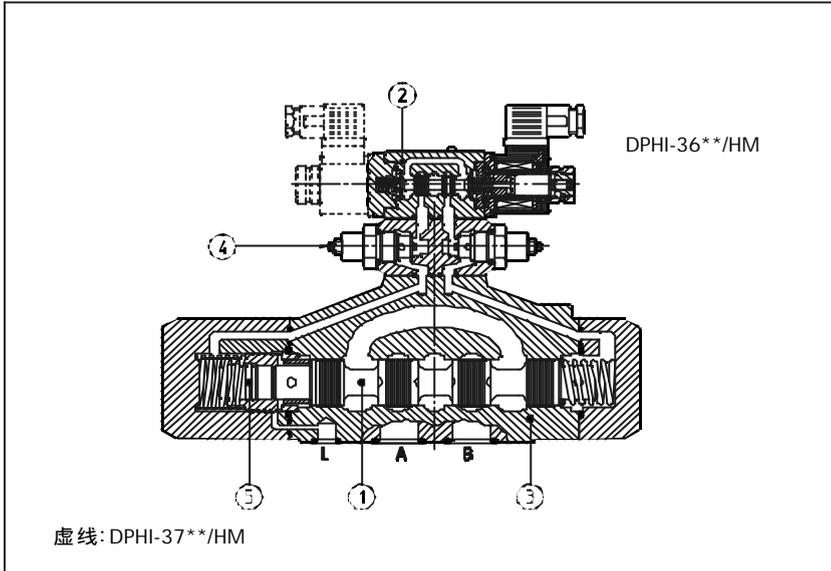
DPHI, DPHU, DPHO 是滑阀类, 两位或三位先导式电磁方向阀, 适用于液压系统。该阀由一个直动式电磁阀所控制:
