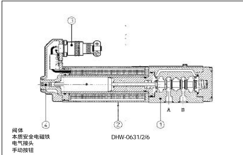
本质安全型开/关电磁阀按照 ATEX94/9/CE 标准制造防护等级为 Ex 1G, Eexia CT6, BT6 或 AT5 (具有易爆气体的地面工厂环境, 区 0, 1 和 2)。
