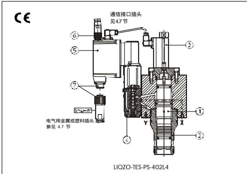
LIQZO-T\* 为二通型比例流量插装阀, 集成块式安装, 根据输入信号的大小提供流量控制。此类阀与电子放大器协同工作, 见第 8 节表格, 放大器向比例阀提供适当的驱动电流, 以校准阀的调整量, 使之与供给放大器的输入信号相对应。
